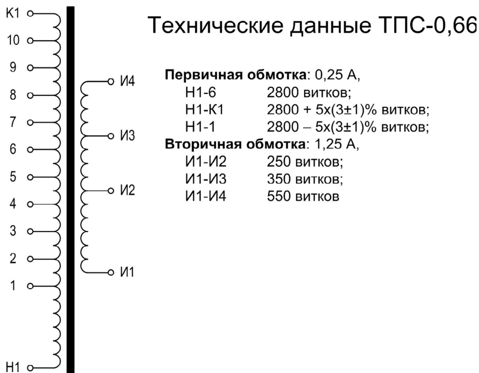
Рисунок 2.4 – Отводы и технические данные ТПС-0,66
